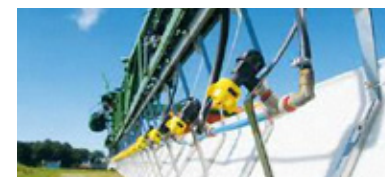
Fig. 17 : Crop tilter ouvrant la végétation pour une meilleure pénétration de la pulvérisation
