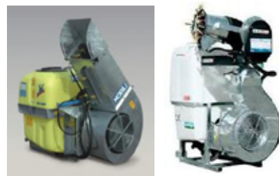
Fig. 19 : Pulvérisateur canon très vulnérable à la dérive
