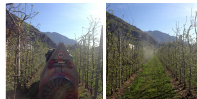
Fig. 6 : Réglage du pulvérisateur en fonction du profil de la végétation
