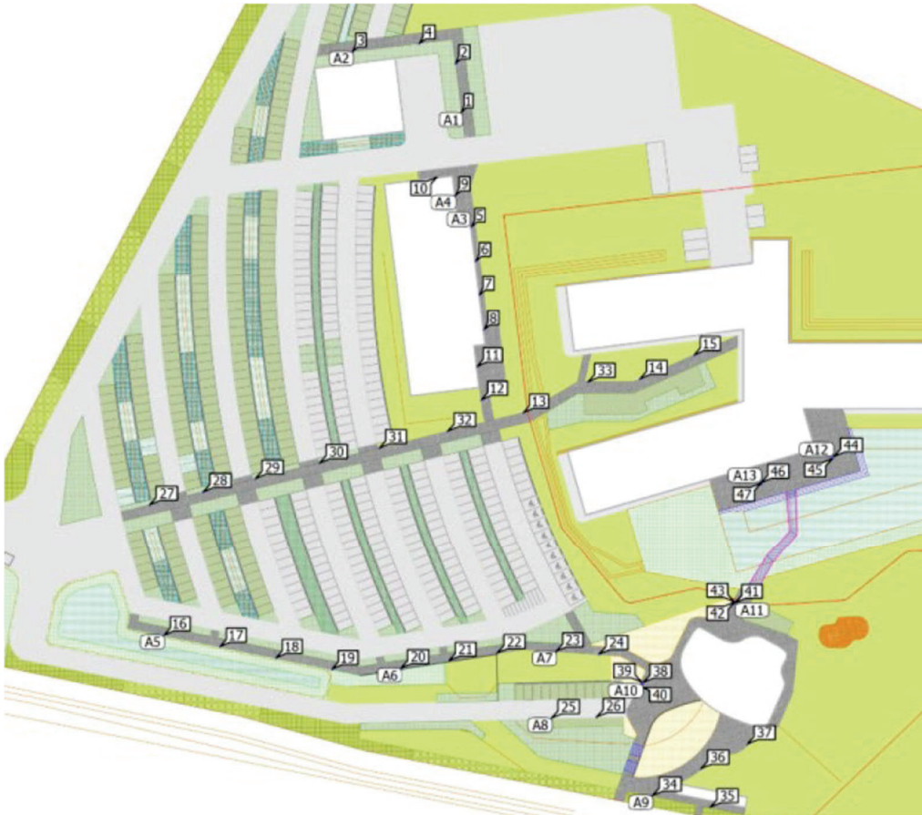
Emplacement des luminaires à l'horizon 2024
