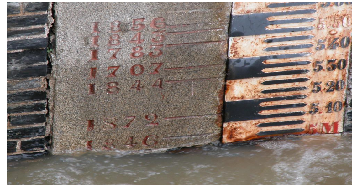
janvier 1994, cote de 5,33 m à l'échelle rive droite du pont Dumnacus (photo DDE 49)
