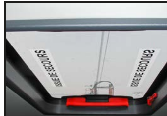
Trappe de toit à utiliser quand le car est couché sur le côté
