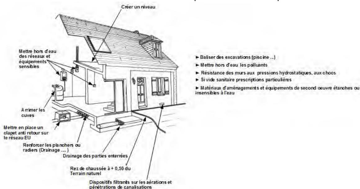
Figure 16: Ensemble de mesures de réduction de la vulnérabilité obligatoires pour les constructions neuves
