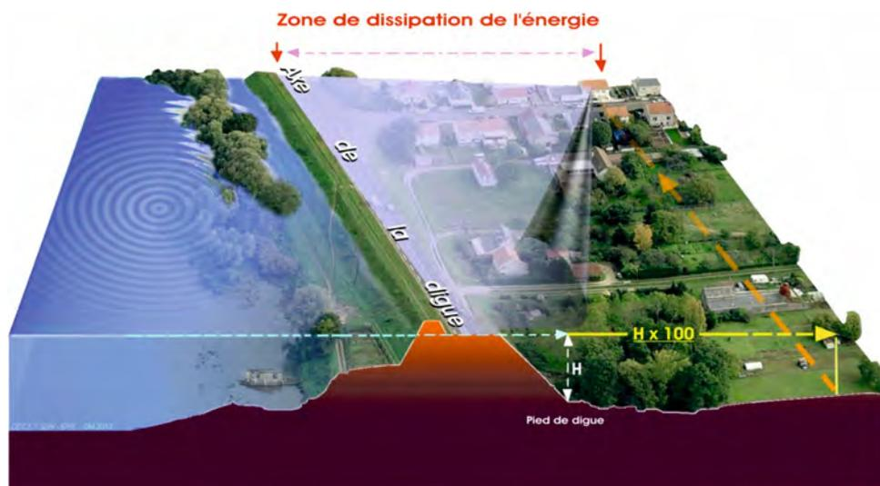
L'études des brèches historiques de la Loire a montré que **la largeur de la zone de dissipation de l'énergie à l'arrière d'une digue est égale à cent fois la différence entre le niveau de protection apparent (correspondant au niveau de surverse) et le niveau du terrain naturel dans le val.**
